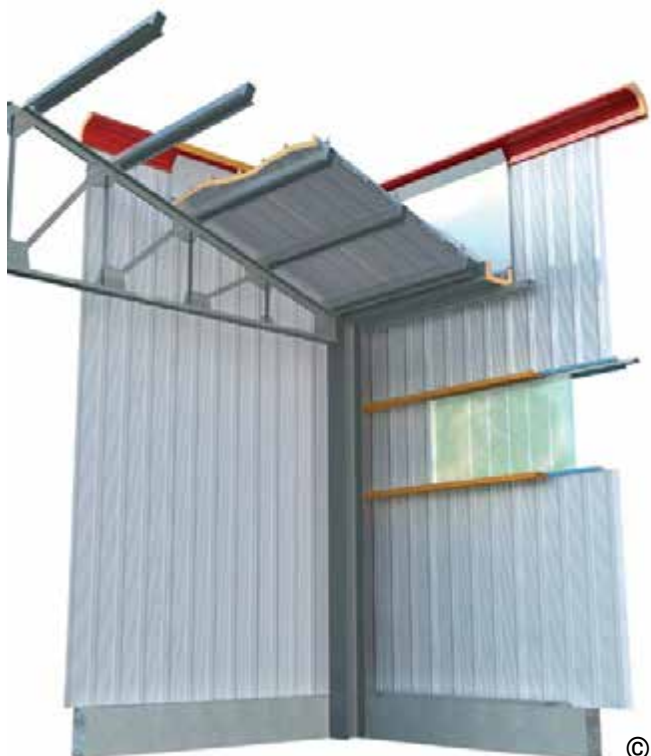
RACCORDO COPERTURA, PARETE, GRONDA (vista dal basso)
