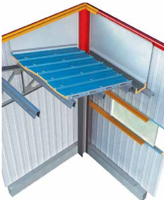
RACCORDO COPERTURA, PARETE, GRONDA (vista dall'alto)
