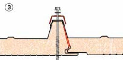
GIUNTO TERMOPARETI® FISSAGGIO NASCOSTO
