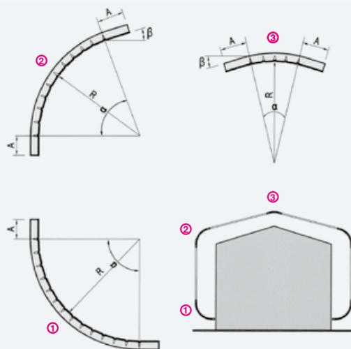
LG 454 Raggio minimo 500 mm. - A = minimo 50 mm
